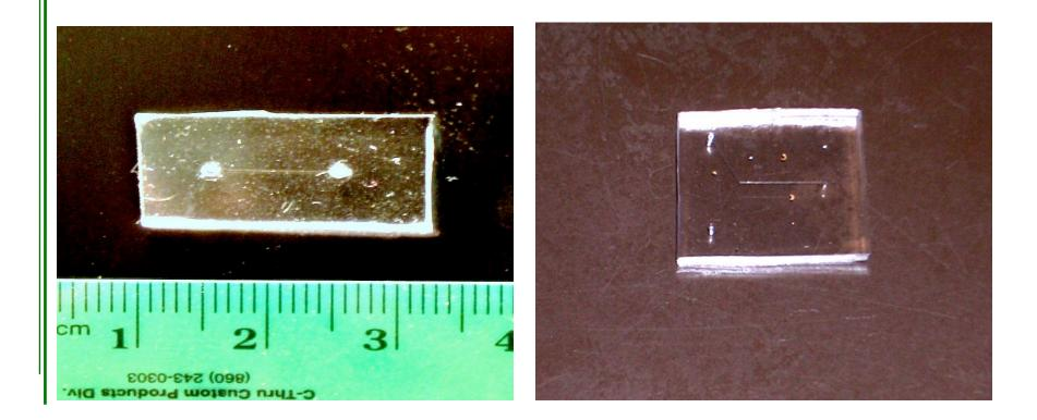
Channel width : 200μm depth : 50 μm
